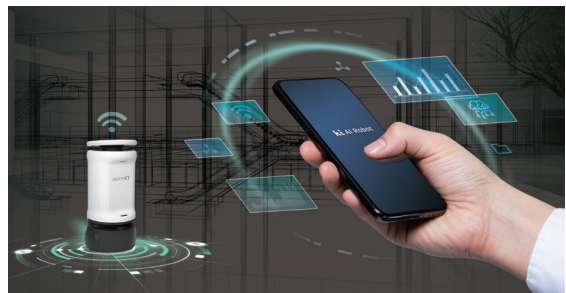
모바일 앱 관리 스마트폰 앱을 이용하여 방역 스케줄링 설정, 음성 멘트/이동 속도 등을 제어하고 로봇 상태정보와 방역 결과 리포트 확인
