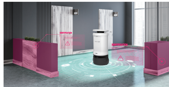
실내 자율주행 방역 라이다(LiDAR) 센서와 3D 카메라 센서를 활용, 장애물을 감지하는 자동 회피주행으로 놓치는 구역 없이 촘촘하게 실내공간을 방역
